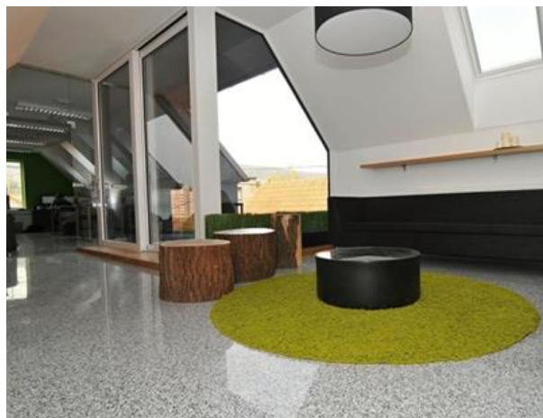
Epoxidová podlaha TERAZZO – administratívny priestor.
